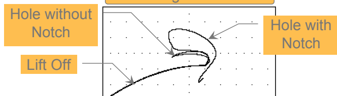
Actual Signals at 2 kHz
